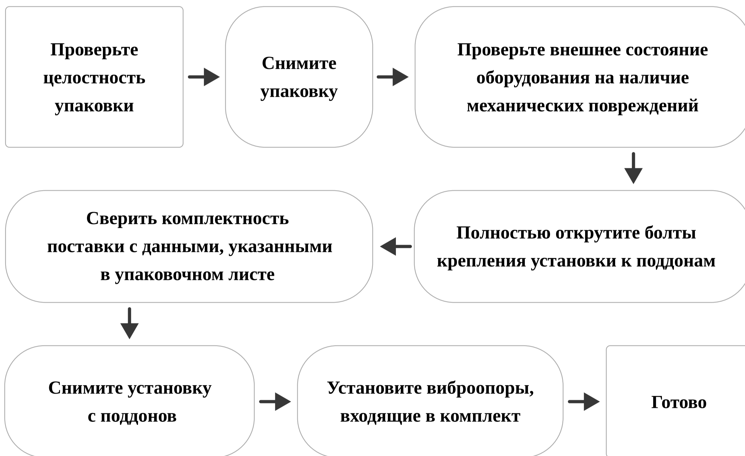
Рисунок – 9. Блок-схема последовательность действий при распаковке НУ
