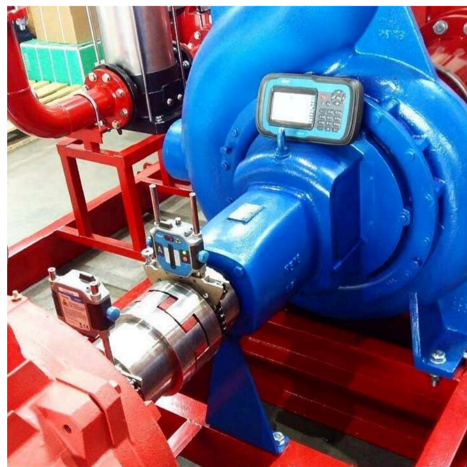
Рисунок – 12. Процесс юстировки консольных насосов
