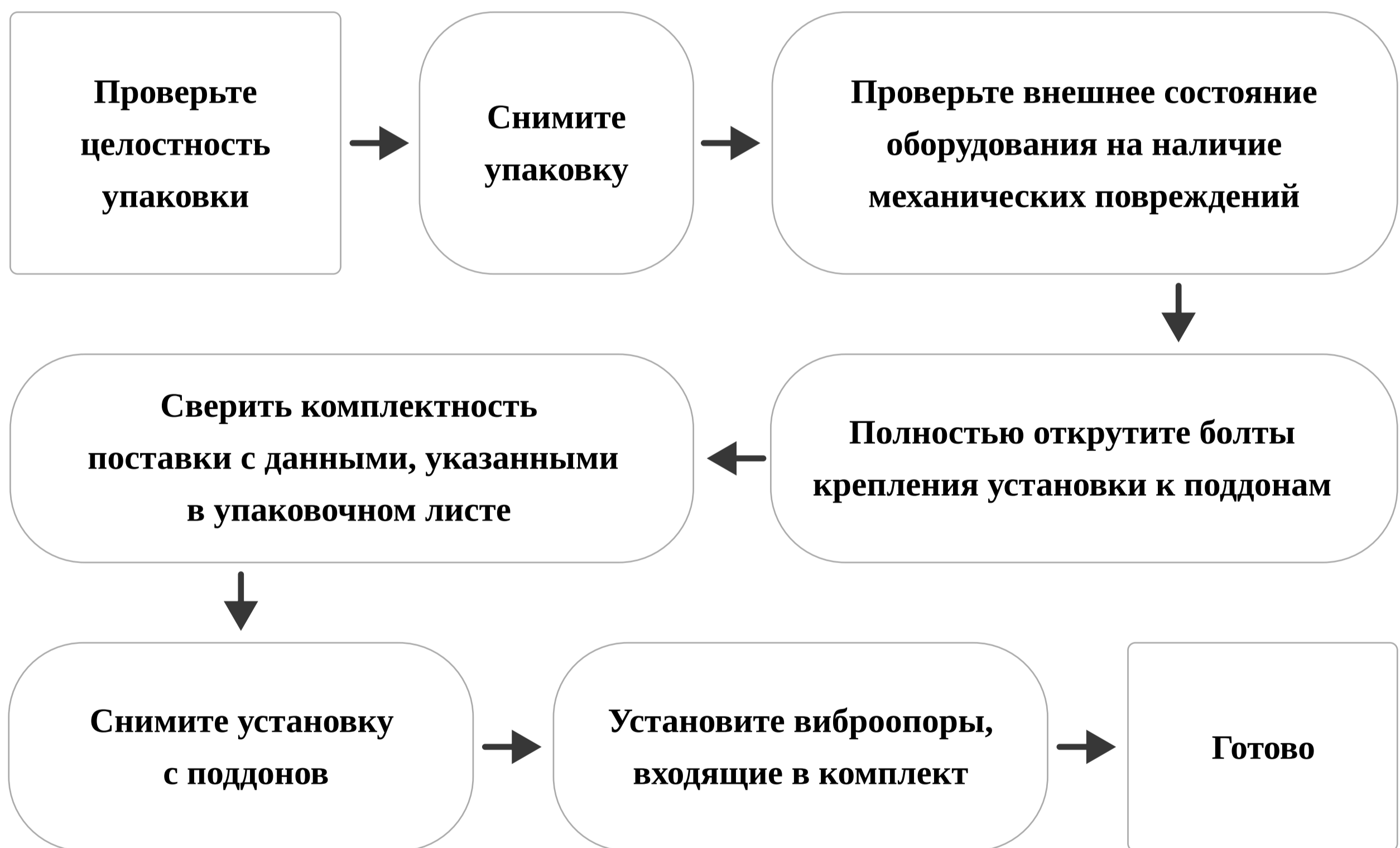
Рисунок – 8. Блок-схема последовательность действий при распаковке НУ
